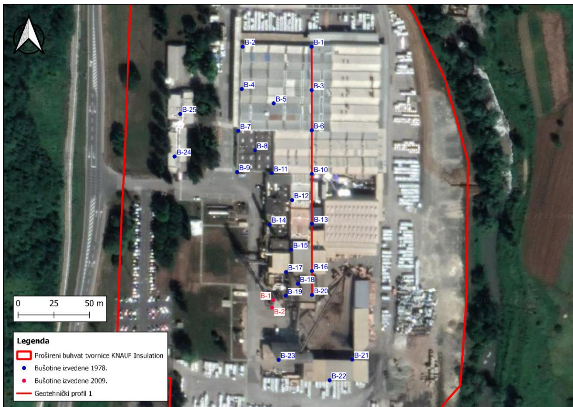
Slika 9. Pozicije izvedenih istražnih bušotina geotehničkih bušotina na lokaciji tvornice za proizvodnju kamene vune Knauf Insulation
