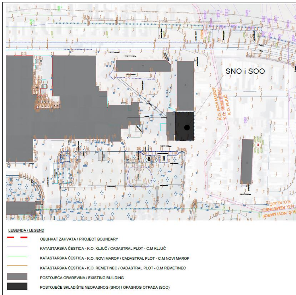
Slika 6. Situacijski prikaz postojećeg dijela postrojenja sa ucrtanom lokacijom skladišta neopasnog (SNO) i opasnog otpada (SOO)
